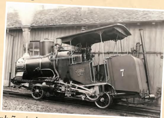
Lok 7 mit dem zwischenzeitlich verbauten liegenden Kessel.
