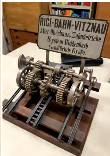
Getriebe alt (links): Modell des originalen alten Antriebes – auf den Weichen nicht fahrbar, da die Untersetzungszahnräder zu tief sind.
