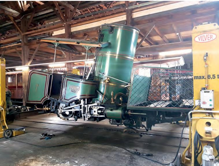
*Nach der Überfahrt nach Goldau wurden die Achsen in der Remise demontiert, gereinigt und geprüft ...*
