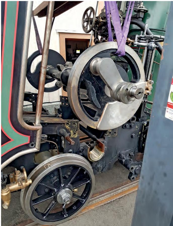
*... später auch die 1996 neu erstellte Kurbelwelle überprüft, die heute über einen geänderten Antrieb verfügt, der direkt auf das Antriebszahnrad wirkt.*
