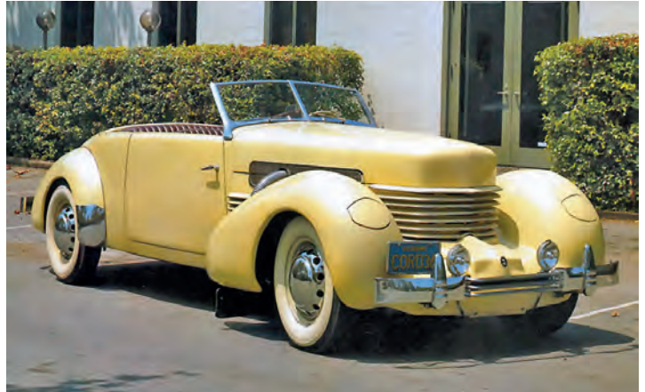
Cord 810 Cabriolet von 1936 mit strömungsgünstigen Klappscheinwerfern
